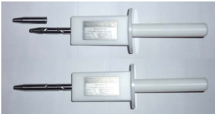
Bild 14: Mögliche Anpassung des Prüffingers bei größeren Gehäuseöffnungen
